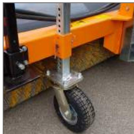
**Ruote di supporto pivotanti regolabili**
