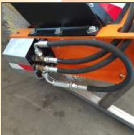
**Motore idraulico spazzola**
