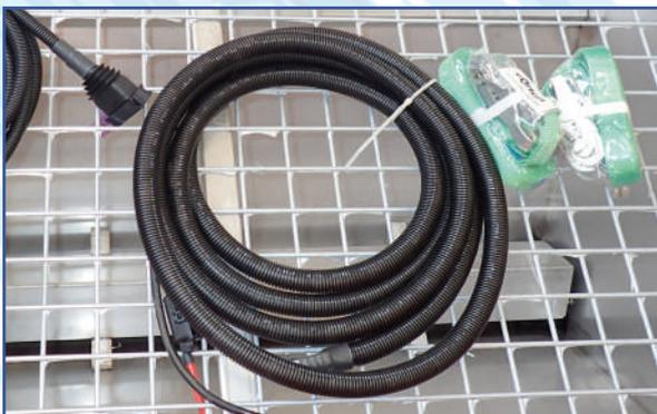
Kit cavi di collegamento batterie e fasce per il fissaggio al mezzo
