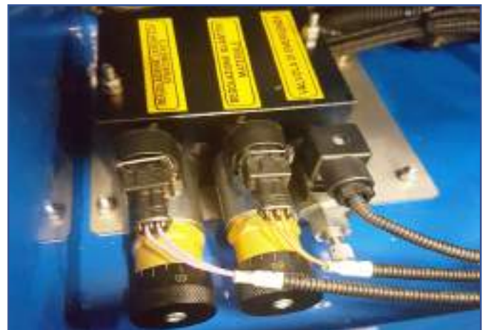
Blocco idraulico proporzionale con opzione di funzionamento in MANUALE (emergenza)
