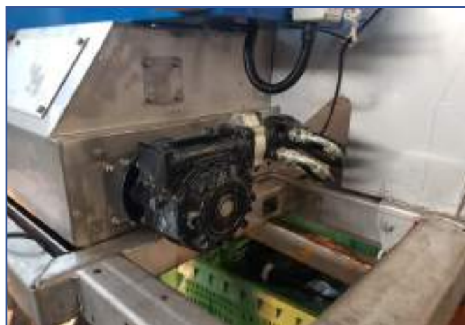
Riduttore per diminuire lo sforzo sul trascinamento
