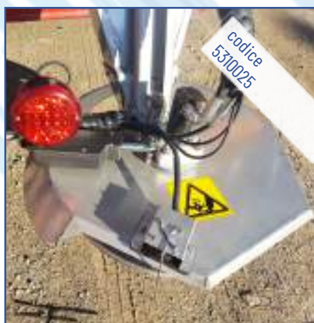
Regolazione elettrica asimmetria di spargimento, comandato da pulsantiera
