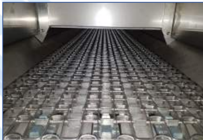
Sistema di spargimento tramite CATENA IN ACCIAIO INOX A NIDO D'APE
