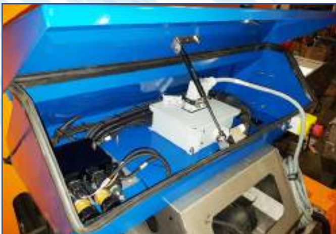
Box ispezionabile per protezione impianto elettrico, idraulico e valvole manuali d'emergenza
