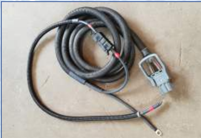
Cablaggio con spina e fusibile per collegamento alla batteria del mezzo
