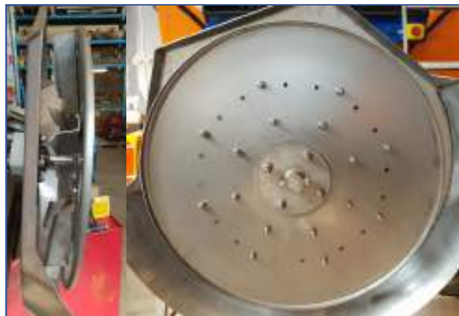
Disco di spargimento Ø 600 mm con n° 8 palette intercambiabili e regolabili
