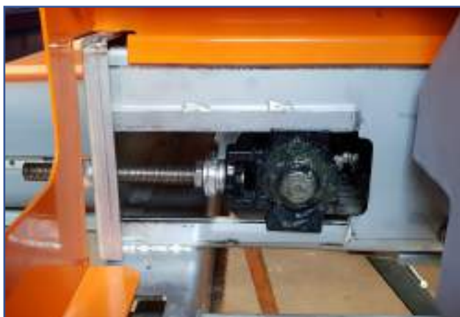
Cuscinetti a tirante anteriori per regolazione tensione catena o nastro in gomma
