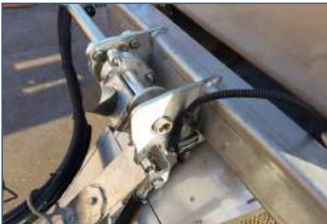
Micro di sicurezza torretta di spargimento
