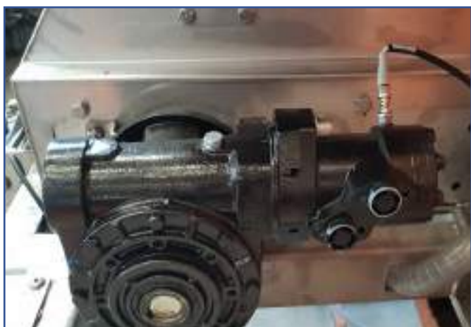
Encoder su motore idraulico per mantenere la precisione di spargimento
