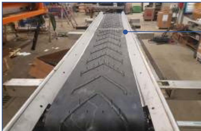
Nastro in gomma larghezza 370 mm con inserti a "V"
