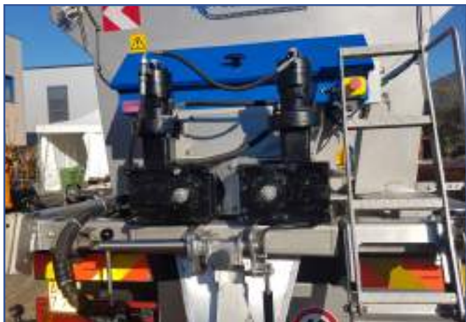
Riduttori per diminuzione dello sforzo sul trascinamento delle coclee
