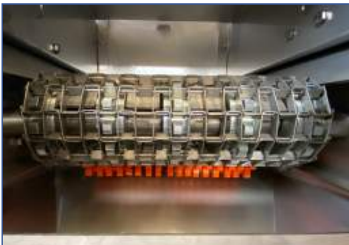
Trascinamento catena tramite 5 ruote dentate
