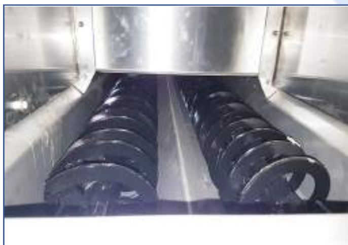
Sistema a doppia coclea completamente ermetico
