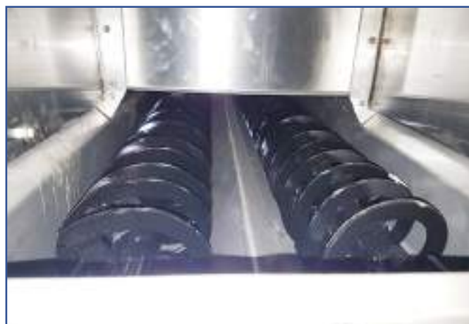
Sistema di spargimento tramite DOPPIA COCLEA A PASSO VARIABILE
