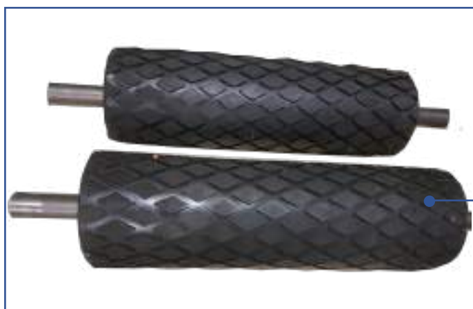
Rulli di trascinamento rivestiti in gomma a zigrinati, per migliorare il grip di trascinamento sul nastro in gomma.
