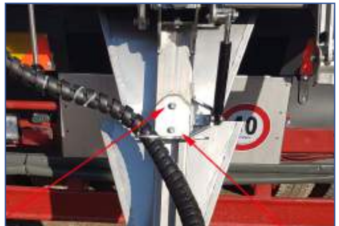
Torretta di spargimento regolabile in altezza
