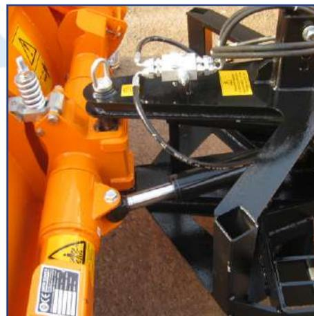
**Cilindro idraulico di orientamento**
