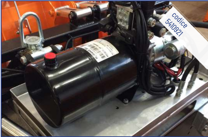
Centralina elettroidraulica (optional) a 24 V con cavo e pulsantiera
