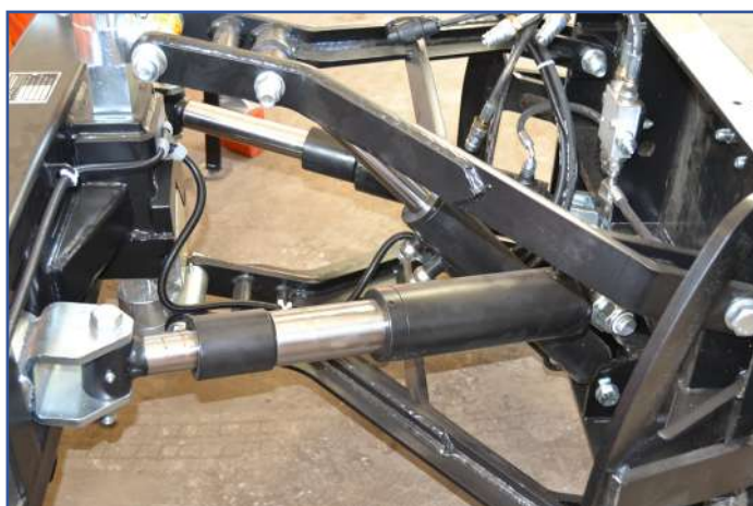
Cilindri idraulici di orientamento a doppio sfilo
