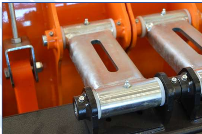
Bielle in acciaio con boccole autolubrificanti in teflon
