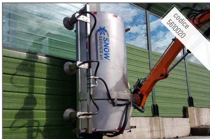
Barra con testine rotanti ad alta pressione
