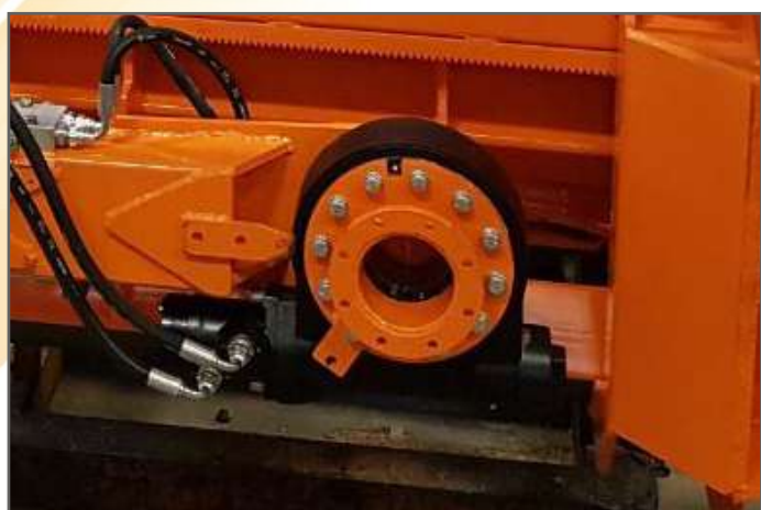
Ralla idraulica per rotazione testata
