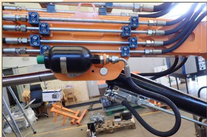
Accumulatore di azoto e valvola di blocco sui cilindri
