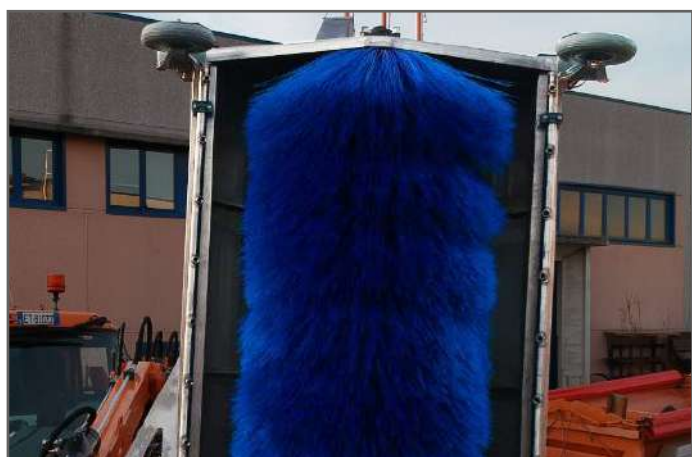
Spazzola di pulizia (D 1000 mm, L 1800 mm)
