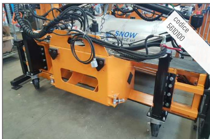
Ruote idrauliche per controllo oscillazione autocarro
