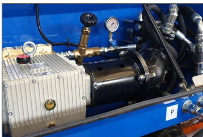
Pompa ad alta pressione a funzionamento idraulico
