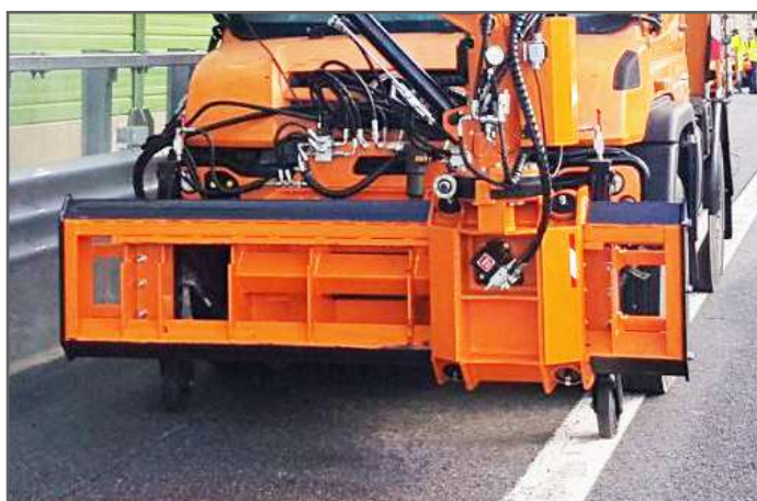
Traslazione laterale idraulica DX SX
