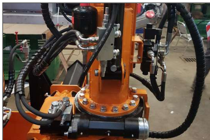
Ralla idraulica per rotazione braccio
