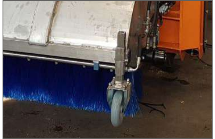
N. 2 barre in acciaio con ugelli intercambiabili
