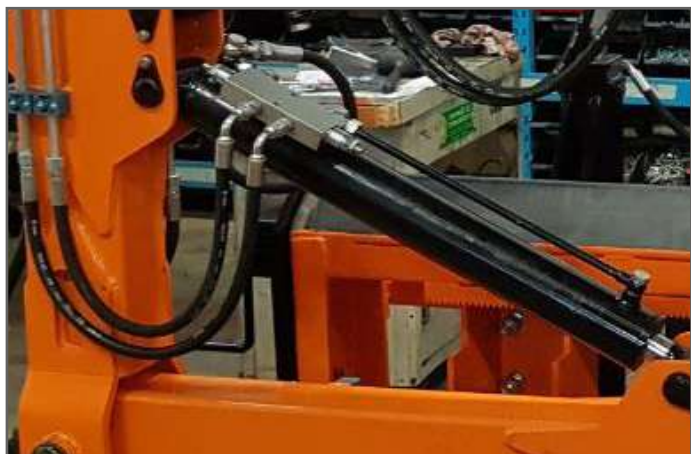
Cilindri idraulici con valvole di blocco
