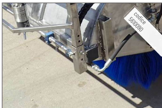
Barra ausiliaria per spruzzare detergente
