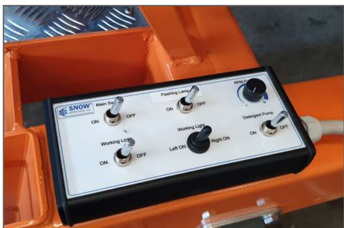
Pulsantiera di comando elettronica
