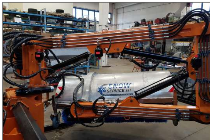
Accumulatori di azoto sui cilindri idraulici per evitare danni dovuti agli urti
