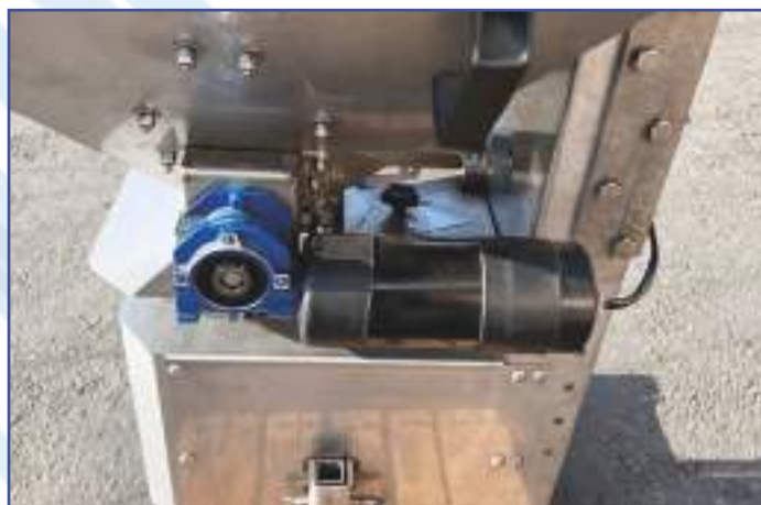
Albero mescolatore esterno tramoggia a funzionamento elettrico
